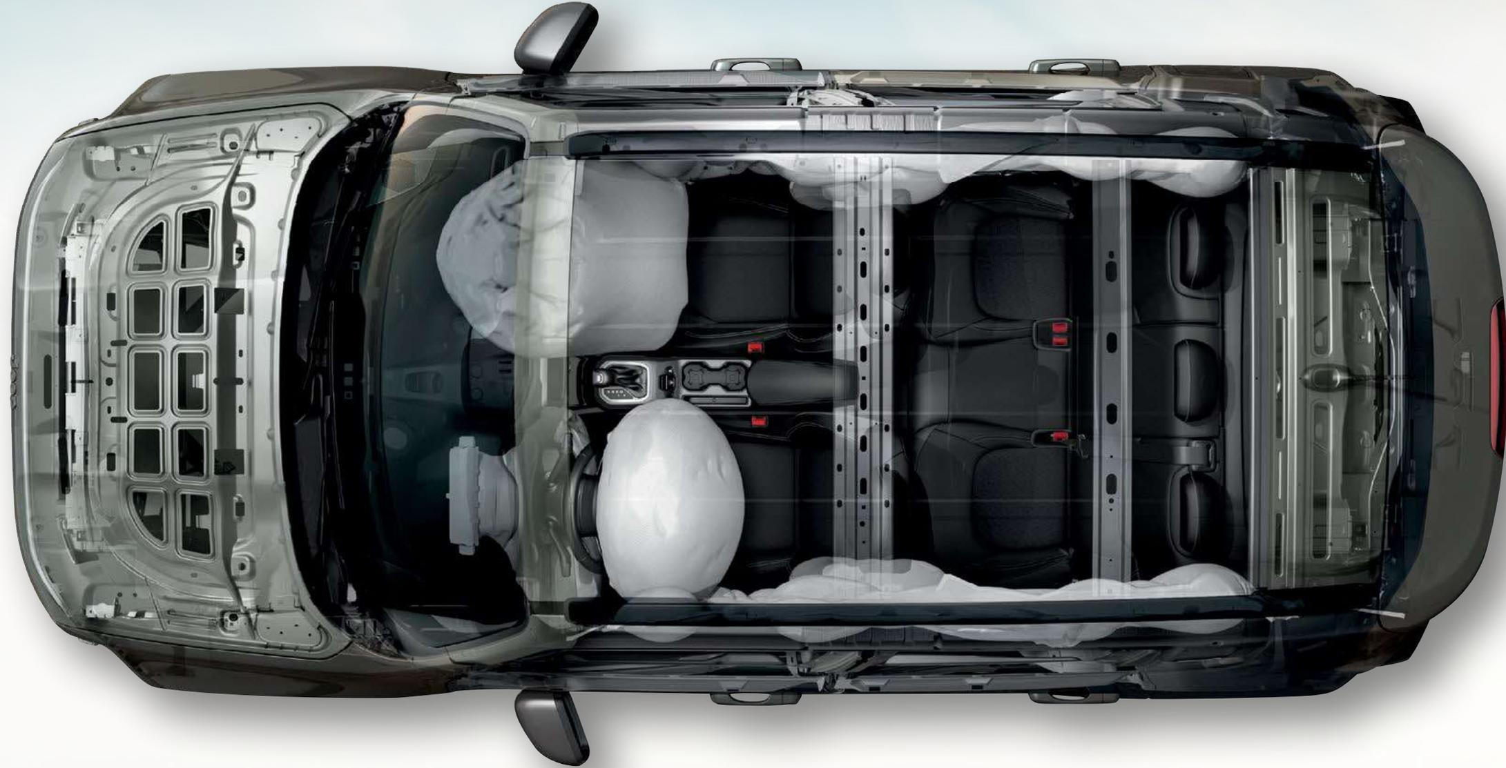
**안전한 에어백 시스템** 측면 및 후면 전체 커튼, 전방 승객용 시트 내장형 사이드 에어백, 고급형 멀티 스테이지 운전석 및 보조석 에어백이 모두 함께 작동하여 탑승자를 안전하게 보호합니다.
